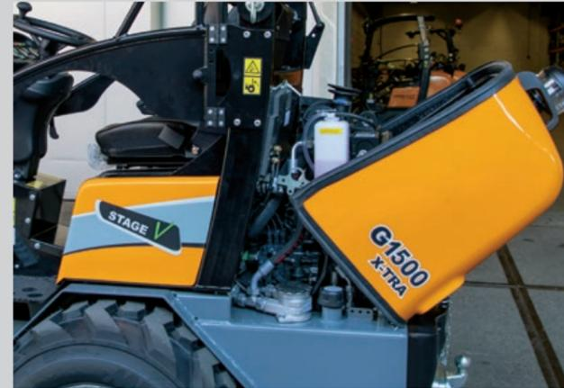
Es ist einfach, die regelmäßig wiederkehrenden Wartungsarbeiten beim G1500 durchzuführen, da die Wartungspunkte gut erreichbar sind. Filter, Hydrauliksystem und Motor sind aufgrund der leicht zu öffnenden Haube und anderer Wartungskappen direkt zugänglich. Somit wird sichergestellt, dass die täglichen Überprüfungen und Wartungsarbeiten schnell und sicher durchgeführt werden können.
